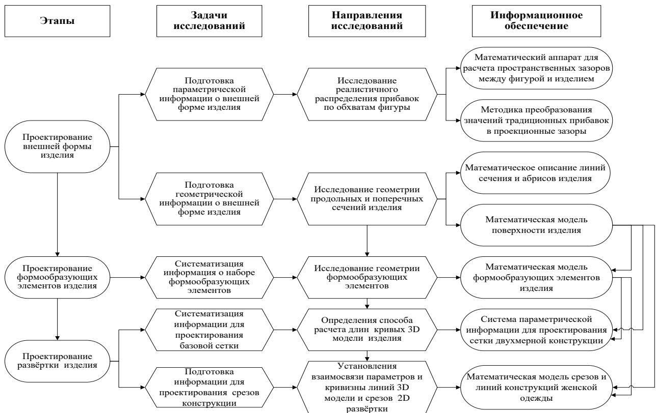
Рисунок 4.1 – Схема метода трёхмерного проектирования швейных изделий
