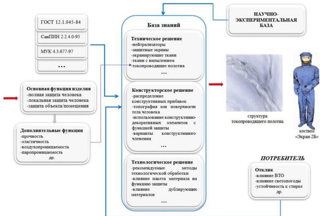
Рисунок 6.4 – Структура организации базы знаний инновационных решений изделий для защиты от электромагнитного излучения
